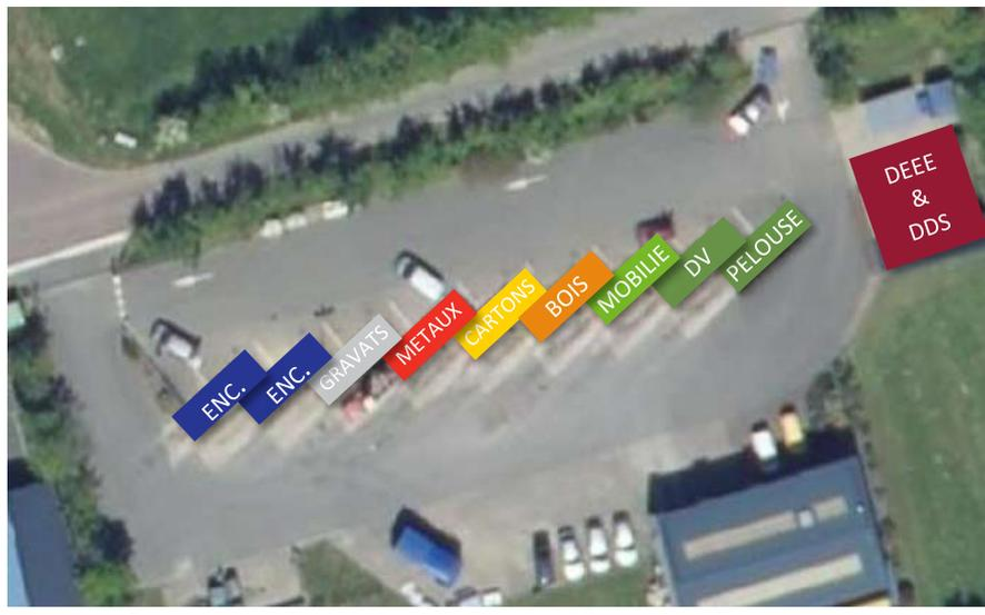
Figure 2 : Vue aérienne de la déchetterie communautaire de La Haye. Y sont visibles les 9 quais où sont positionnées 9 bennes de 20 à 30m<sup>3</sup>, le local ouvert pour DEEE et DDS (toit gris à droite), le local fermé pour DDS (toit blanc à droite), le bureau du gardien de déchetterie (toit bleuté en haut à droite) et la benne d'amiante de 15m<sup>3</sup> (en bas).
