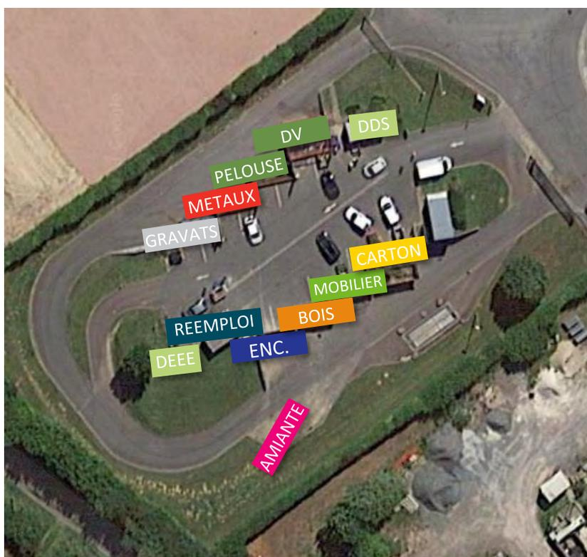
Figure 4 : Vue aérienne de la déchetterie communautaire de Périers avec ses 8 bennes à quai, 1 benne en bas de quai, l'espace DDS et DEEE.
