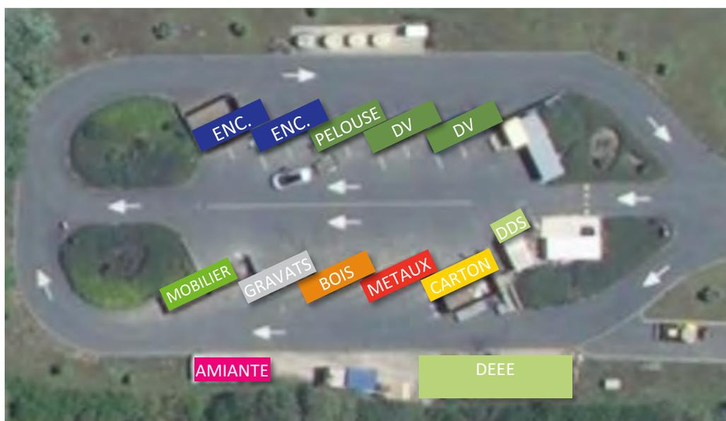
Figure 3 : Vue aérienne de la déchetterie communautaire de Créances avec ses 10 bennes à quai, 1 benne en bas de quai, l'espace DDS et DEEE.
